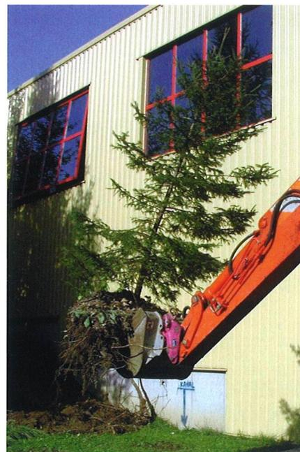
Bäume und Sträucher werden beschädigungsfrei mittels „Hochlöffelausrüstung“ ohne teure Spezialwerkzeuge versetzt.
