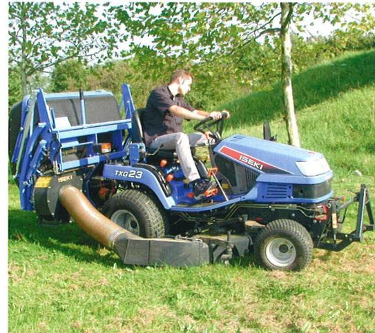
anbaugeräte. Die sehr leistungsstarke Schlepperhydraulik ermöglicht den Antrieb hydraulisch betriebener Anbaugeräte wie Frontkehrmaschine. Dieses Antriebskonzept reduziert Pflegeaufwand und Geräusentwicklung beim Einsatz enorm. Das gut abgestimmte Sortiment an Mähwerken, Grasaufnahmegeräten, Schneeschildern uvm. kann natürlich mit dem TXG wirtschaftlich genutzt werden.
