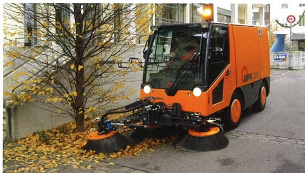
*Kompakt-Straßenkehrmaschine Aebi MFH 2500: Feinstaubarmes Arbeiten mit dem einzigartigen Koanda-System und hohe Wendigkeit dank Vierradlenkung.*
