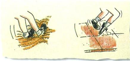
Looser Fallschutz wird im Vergleich zu Fallschutzmatten beim Aufprall weggeschoben
