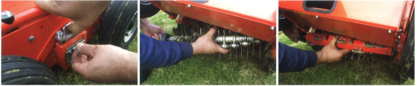
Mit dem einzigartigen Schnellwechselsystem ist ein Auswechseln des Messerrotors innerhalb von nur einer Minute (!) möglich:
