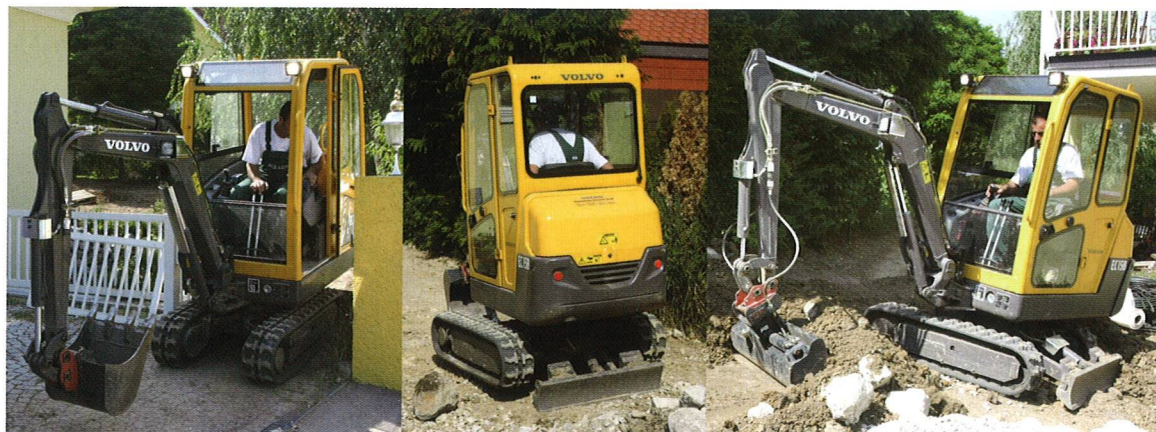
Volvo EC15B-XTV, kleinster Volvo-Bagger mit verstellbarem Laufwerk, von 98 cm auf 1,33 Meter
