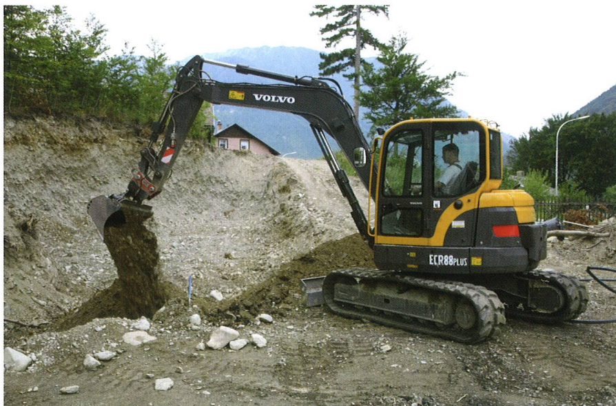
ECR88PLUS – der größte der 5 Rundheckbagger aus dem Hause Volvo
